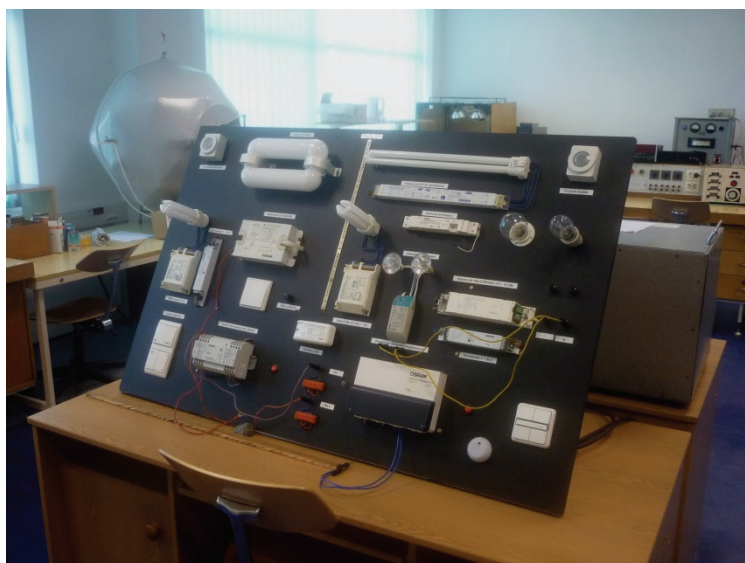
Stanowisko dydaktyczne do badania układów zasilania źródeł światła (fot. M. Kobusiński)
