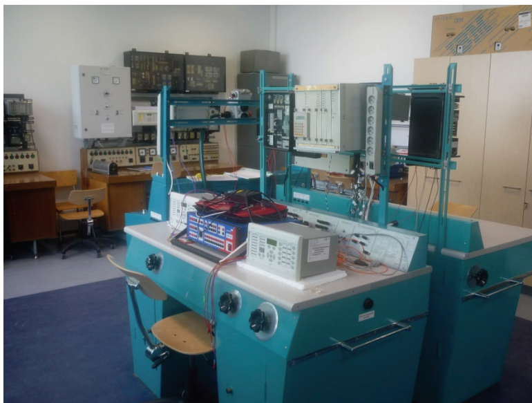
Widok ogólny Laboratorium Zabezpieczeń Elektrycznych, na pierwszym planie stanowisko do badania zabezpieczeń różnicowych linii (fot. M. Kobusiński)
