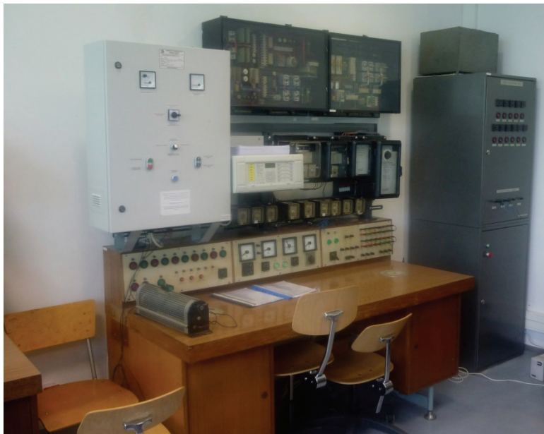
Stanowisko do badania zabezpieczeń generatora synchronicznego(fot. M. Kobusiński)
