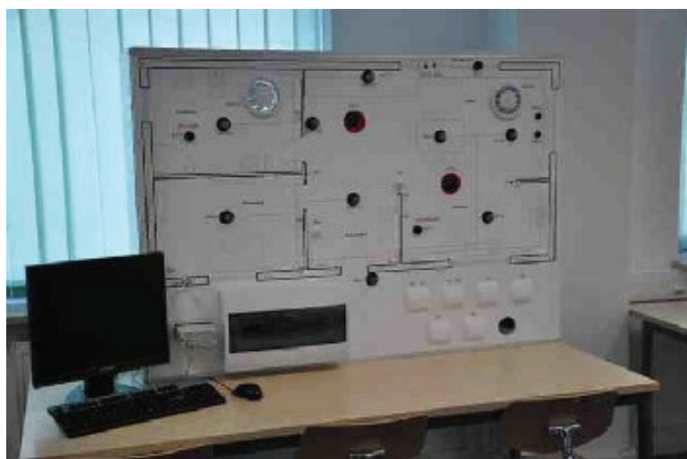
Stanowisko laboratoryjne instalacji inteligentnej systemu LCN (fot. M. Kobusiński)
