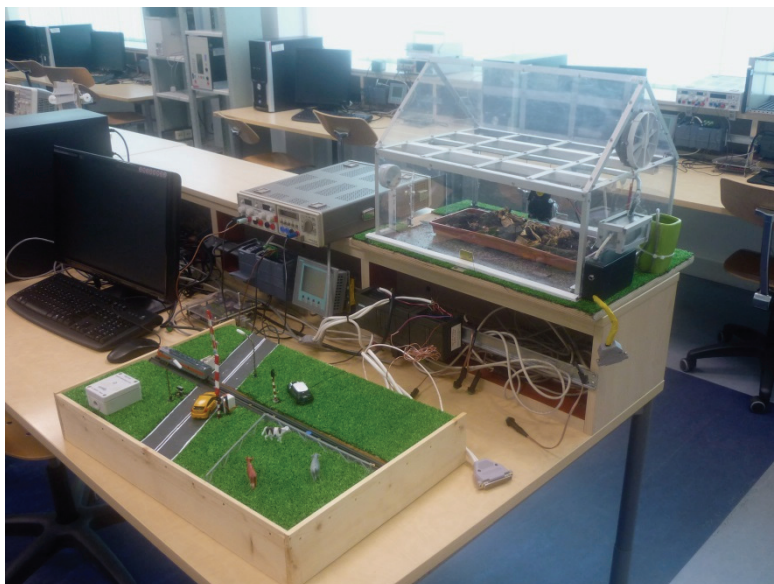
Modele układów sterowania przejazdu kolejowego oraz szklarni z wykorzystaniem PLC (fot. M. Kobusiński)
