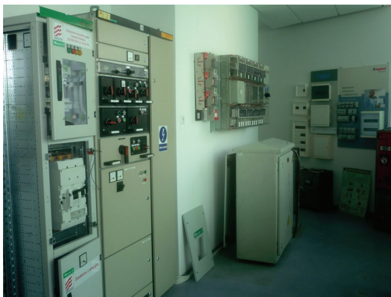
Stanowisko laboratoryjne do badania rozdzielnic niskiego napięcia (fot. M. Kobusiński)
