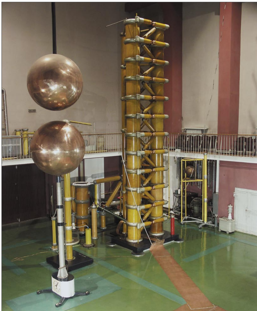
Generator napięcia udarowego 1,8 MV, 15 kJ z iskiernikiem kulowym o średnicy elektrod 150 cm
