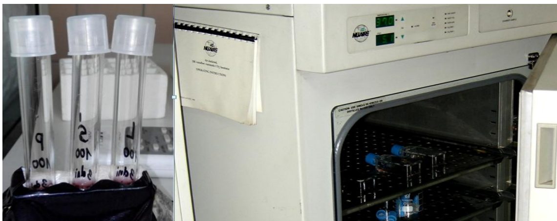
Rys. 2. Prototyp stanowiska ekspozycyjnego zintegrowanego z urządzeniem do prowadzenia hodowli komórkowych w kontrolowanych warunkach
