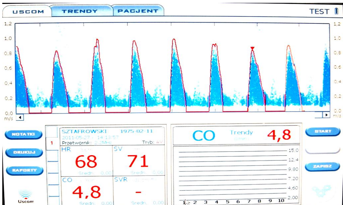
Rys. 2. Monitor nieinwazyjnego pomiaru rzutu serca USCOM 1A. Widok ekranu podczas prowadzonych badań hemodynamiki serca
