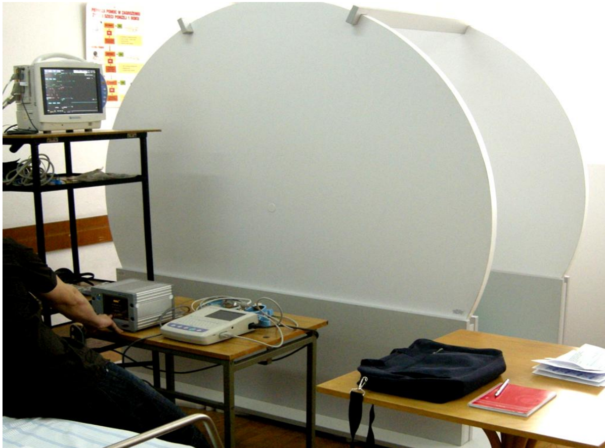
Rys.1. Stanowisko badawcze do ekspozycji w jednorodnym polu magnetycznym w trakcie integracji z systemem monitoringu funkcji życiowych człowieka
