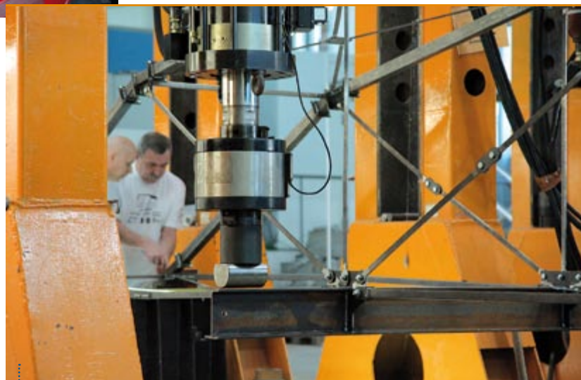
...gdzie poddano je próbie obciążeniowej na siłę pionową przyłożoną w środku rozpiętości modelu
