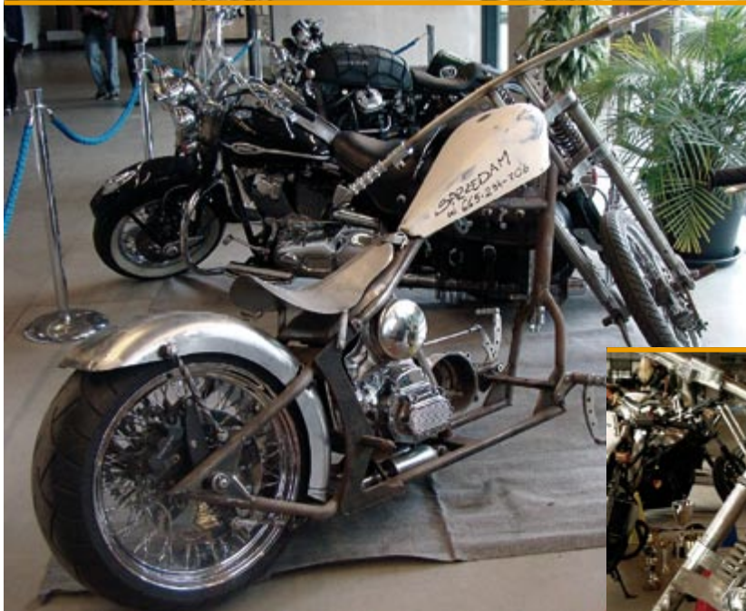
Chopper – wydłużona rama i tył nadwozia, długi widelec oraz brak tylnego zawieszenia
