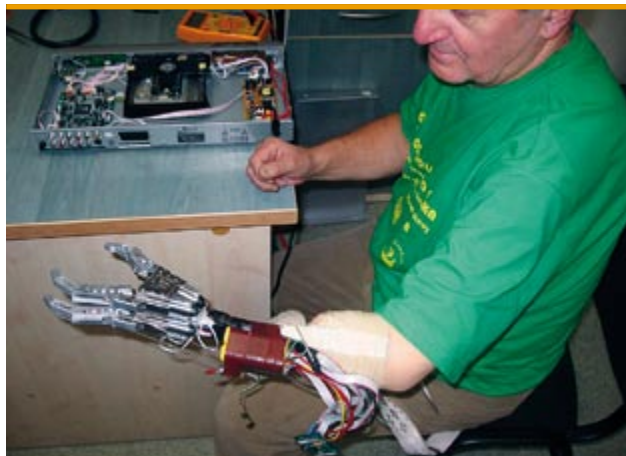
Zamontowana proteza ręki na kikucie z systemem sterowania (bez obudowy kosmetycznej)
