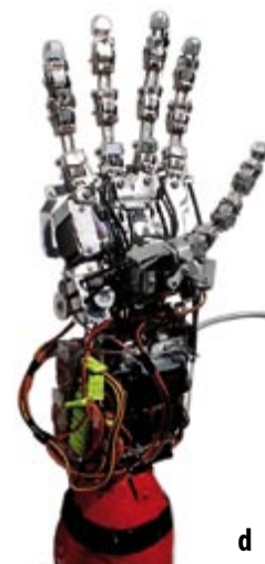
Opracowane modele: (a, b) – rozwiązania komercyjne, (c) rozwiązanie studyjne o dużej funkcjonalności, (d) – model studyjny o wielu stopniach swobody
